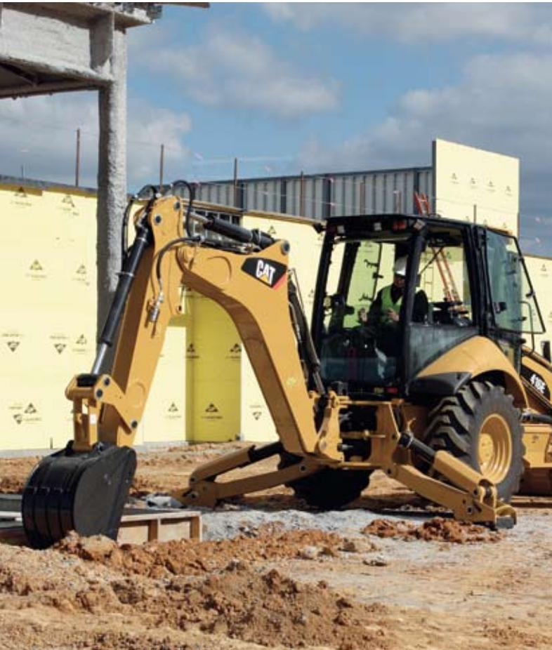
O 416E tem um sistema hidráulico de centro fechado com sensor de carga, que associa a potência e o fluxo à demanda dos implementos. Então, se você está no modo de escavação de valetas ou escavando delicadamente ao redor de um obstáculo, você está no controle. Em aplicações como valetamento de produção, a velocidade é importante e o sistema ajustará o fluxo necessário para que o trabalho seja feito rápida e eficientemente. O sistema hidráulico sensível à carga também proporciona:
